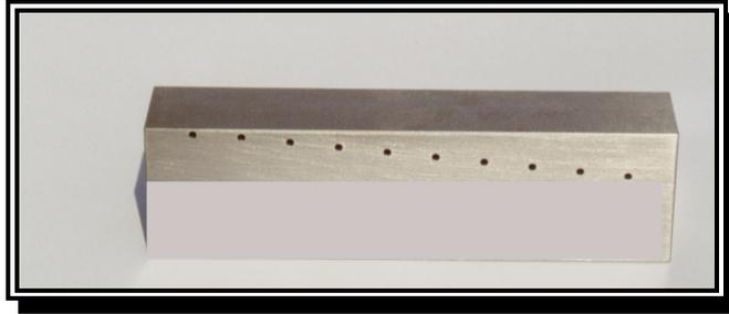
Le témoin A est un excellent moyen pour vérifier la polarité des bobines d'aimantation, ainsi que l'efficacité de l'aimantation longitudinale.
